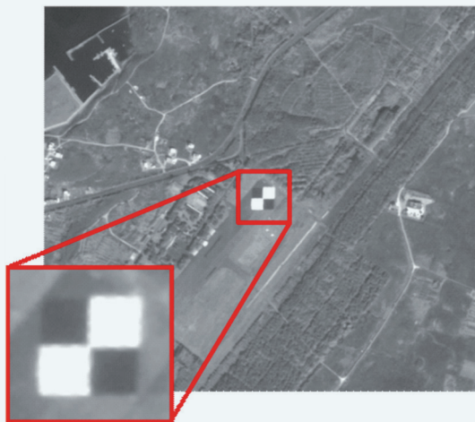
國家太空中心於澎湖建置影像校正場，以檢測影像的清晰與銳利度來確認衛星的健康狀況。
