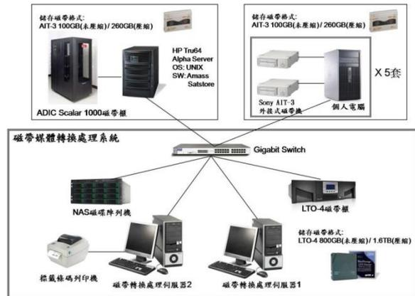
圖 7 磁帶資料轉換系統
