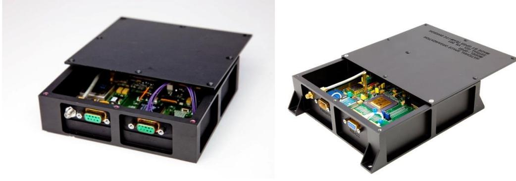
圖 1 商用現成電子零件版本(左圖)與太空等級版本之導航接收機(右圖)
